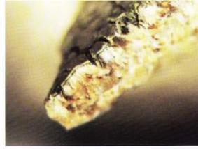
Fig. 9. Lichene di tipo crostoso osservato in sezione a piccolo ingrandimento (10X). Si può osservare al di sotto dello strato corticale superiore una zona verde contenente le alghe. Nella parte inferiore si osserva la presenza di cristalli di calcite inglobati dal tallo lichenico per la profondità di qualche mm.
